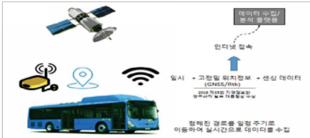
[그림 7] 버스에 설치된 wifi를 이용해 데이터를 수집하기 위한 개념도
